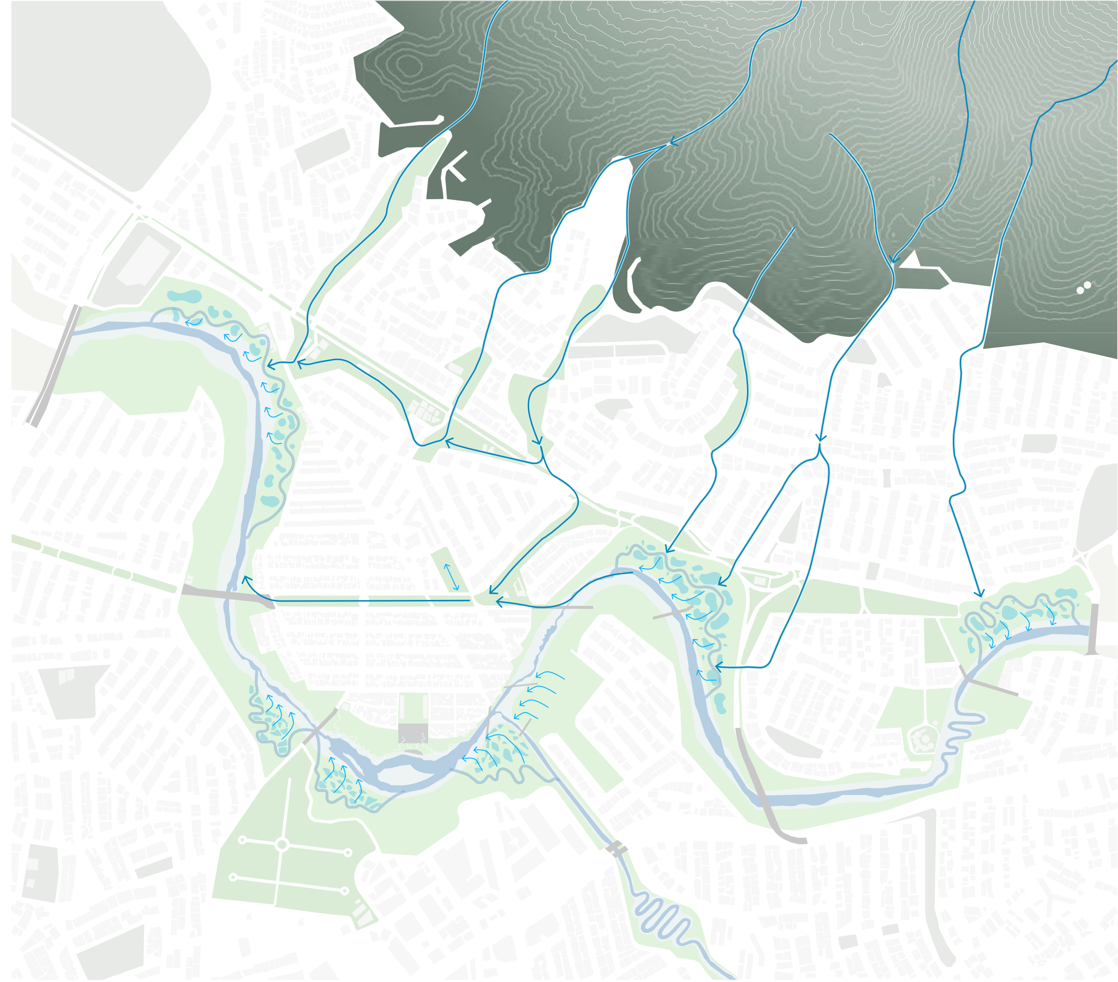
Implementación de acequias y rehabilitación de banquetas en escorrentías
